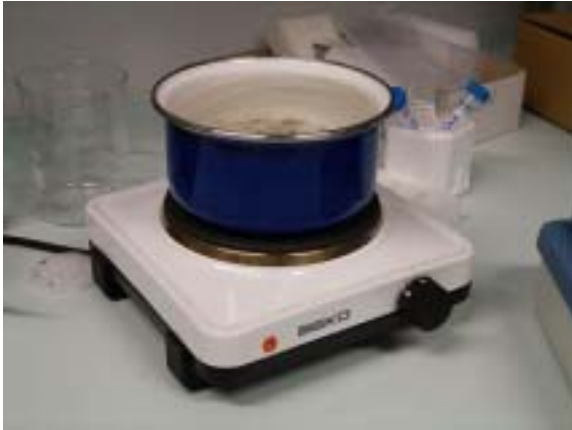
沸とう浴槽を準備する。 (DNA purifying slurry処理、Proteinase Kの失活に使用)
