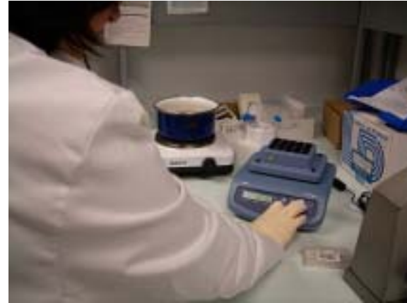
サーモミキサーを 55 にセットする。 (Proteinase K 処理に使用)
